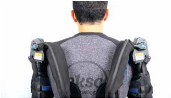
Abbildung 10: Korrekte Ausrichtung des Federantriebs. Die Federantriebe müssen sich auf gleicher Höhe befinden.
