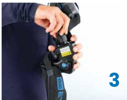
3. Lösen Sie den Schnappverschluss und den Riemen neben der Gasdruckfeder. Drehen Sie die Gasdruckfeder heraus und entnehmen Sie sie aus der Zylinderkammer des Federantriebs.
